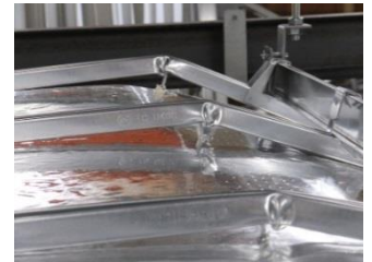
図7 野縁の座屈とビスの引き抜け(試験体中央部)【エンボスタイプ】
