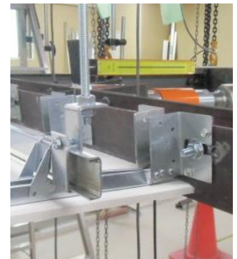
図6 野縁の局部座屈状況 (端部固定箇所)
