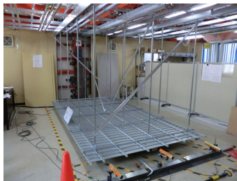
写真4 水平載荷試験状況
