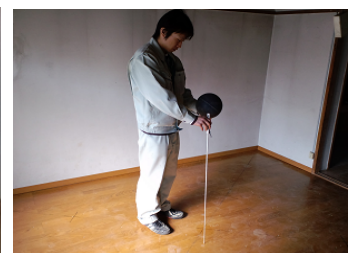
写真2 インパクトボールによる加振状況
